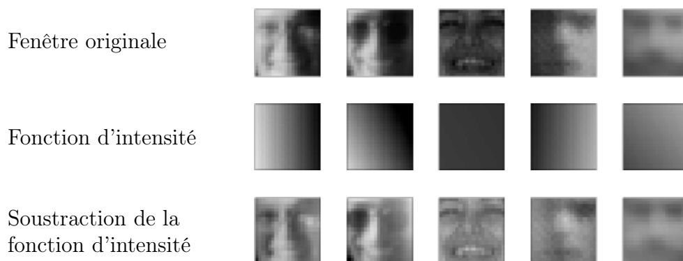
FIG. 4 – Calcul et application du filtre d'égalisation d'intensité
