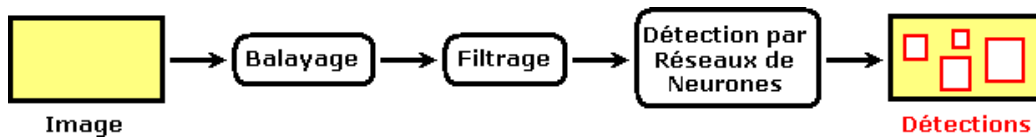
FIG. 1 – chaîne de traitement de la détection
